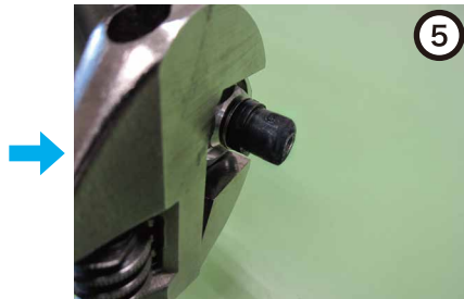
バルブを固定している外側のナットを モンキーレンチで緩めて外す
