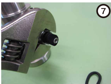
バルブの六角ナット部分をモンキー レンチで緩めて外す
