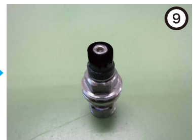
バルブの先端にある樹脂製の黒いパー ツにレバーの付け根が食い込むこと によりハンドルの上げ下げする仕組み になっており、樹脂製のパーツが破損す るとレバーが空回りする
