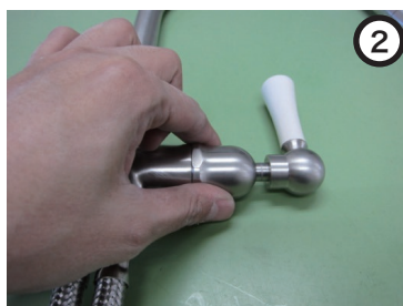
エスキャッションを外す ※手回しで外れる ハンドル部分も取れる
