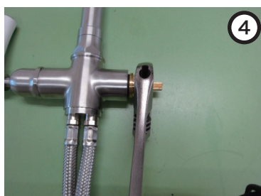
六角ナット部分をモンキーレンチで 緩めて外す
